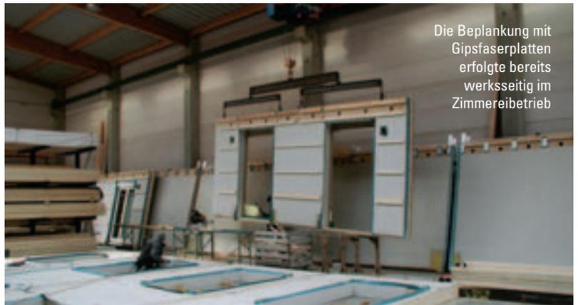
Die Beplankung mit Gipsfaserplatten erfolgte bereits werksseitig im Zimmereibetrieb
